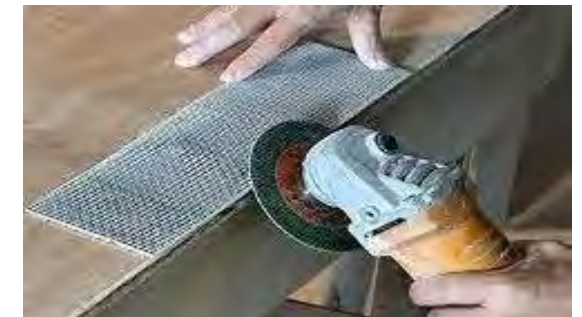
⑥角グラインダーで製品の縁を研磨し、縁を平らにする。
