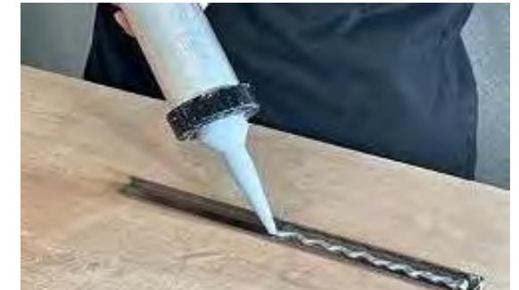
②収辺条の貼り付け面に構造用接着剤を均一に塗る。
