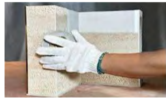
⑥半乾きになったらサンディングホイールで縁を研磨し、角をより平らにする。
