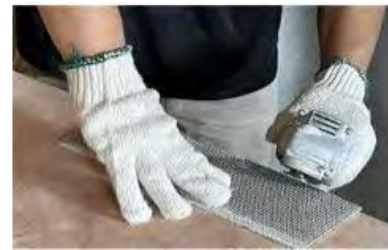
①角グラインダーを使って製品の粗い縁を整える。
