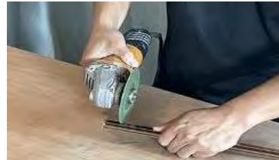
①手持ち切断機または木工台を使ってマーキングした位置で切断する。
